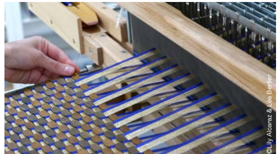
Tissage sur métier à tisser manuel. Imbricata, bois, coton et fils métallisés
